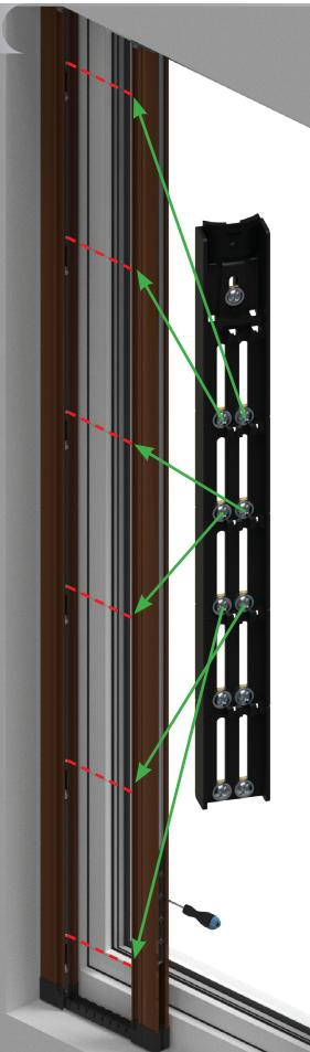
■ Schraube, die die Spannung der Schnur reguliert, befindet sich im breiten verschiebbaren Profil. Passen Sie die Spannung der Schnur an, indem Sie die Schraube entlang der Nut verschieben, und ziehen Sie die Schraube dann fest. Stellen Sie sicher, dass sich das Profil mit dem Netz reibungslos bewegt und überprüfen Sie, ob die Schnurspannung korrekt ist.
